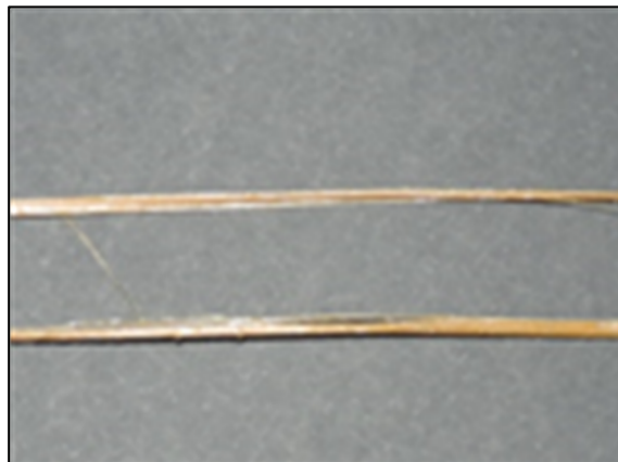
Fig. 3. Fibra de Bambu com Resina.
